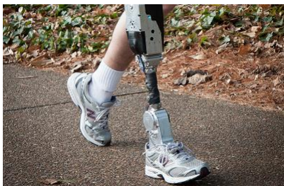
Una protesi robotica per gli arti amputati transfemorali Una protesi robotica per le amputazioni transtibiali
