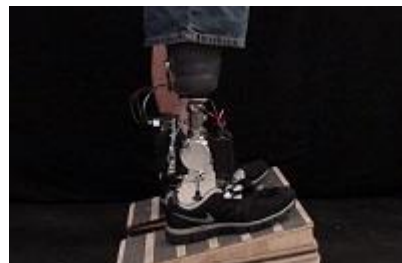
Una protesi robotica per gli arti amputati transfemorali Una protesi robotica per le amputazioni transtibiali
